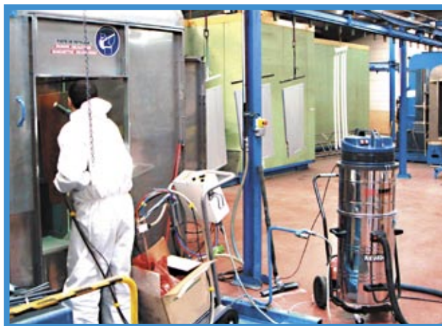
Aspiration pour nettoyage de l'environnement et de la cabine de poudrage
